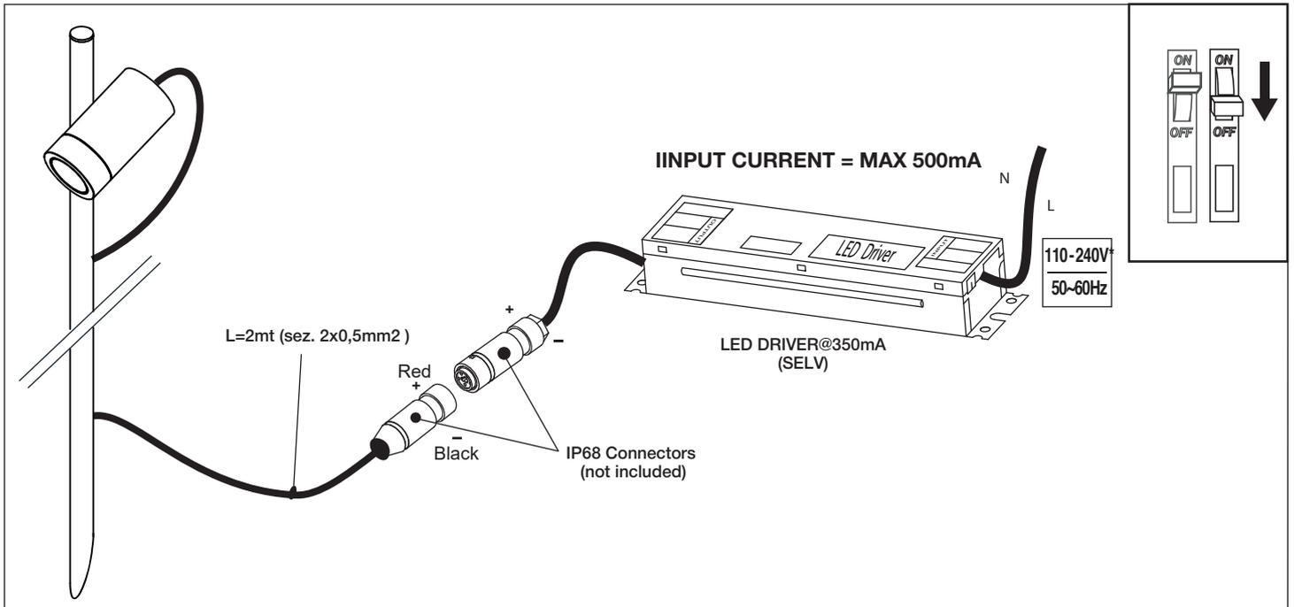
**Cablaggio raccomandato per installazioni outdoor - Recommended wiring for outdoor installations**
