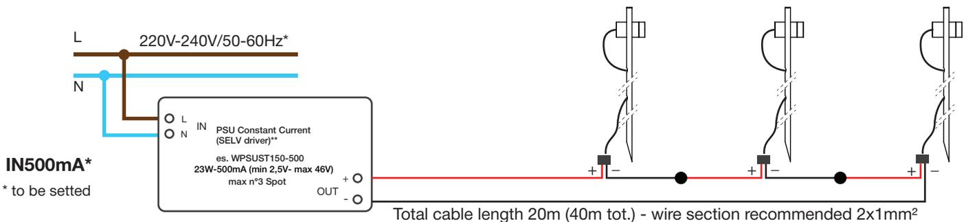
\* Verificare la tensione di ingresso supportata dagli alimentatori / Verify the input tension supported from drivers.
