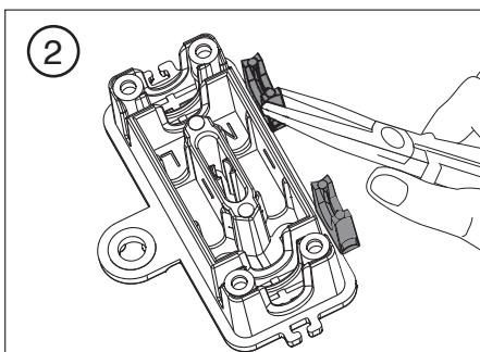
Installare l'adattatore per il cavo della lampada e collegare i conduttori alla morsettiera.(cavo della lampada Ø3,4mm)
