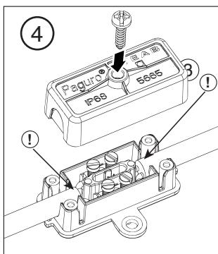
Montare la copertura in gel sulla base e premere con decisione per assicurarsi che la copertura sia correttamente posizionata.
